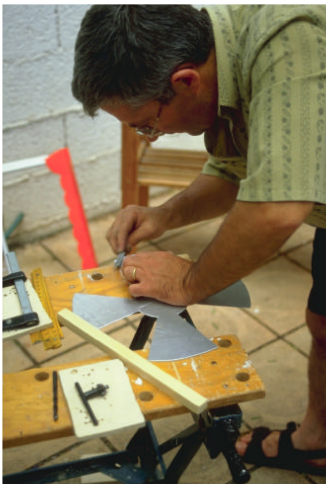
Foto 7 : José deed het secure werk. Gladvijlen en zo zuiver mogelijk gelijke bladen maken. Een sector zagen is iets ingewikkelder dan simpelweg een werpster uit een plaat aluminium zagen.
