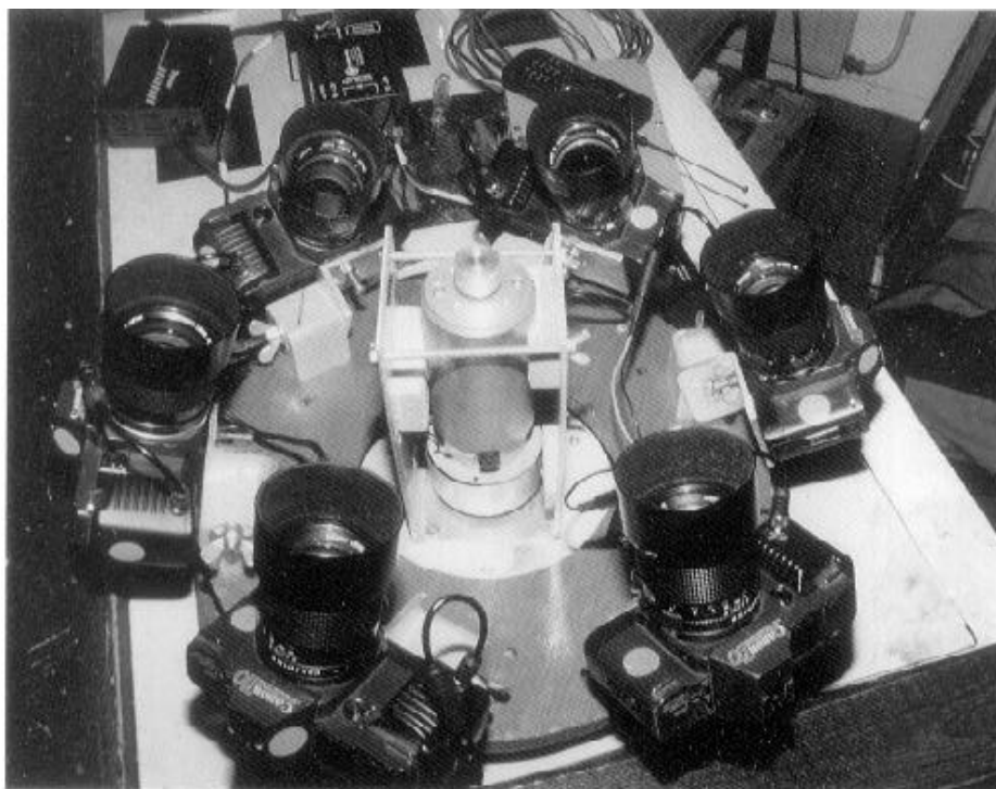
Foto 1 : Momenteel in tweevoud gebouwd : Camerabatterij met zes stuks Canon T-70 met Canon FD f/1.8-85 mm optiek. Het geheel is geautomatiseerd via de Canon Command back 70. De kristalgestuurde sectormotor (zonder sectorblad) is in het midden zichtbaar.
